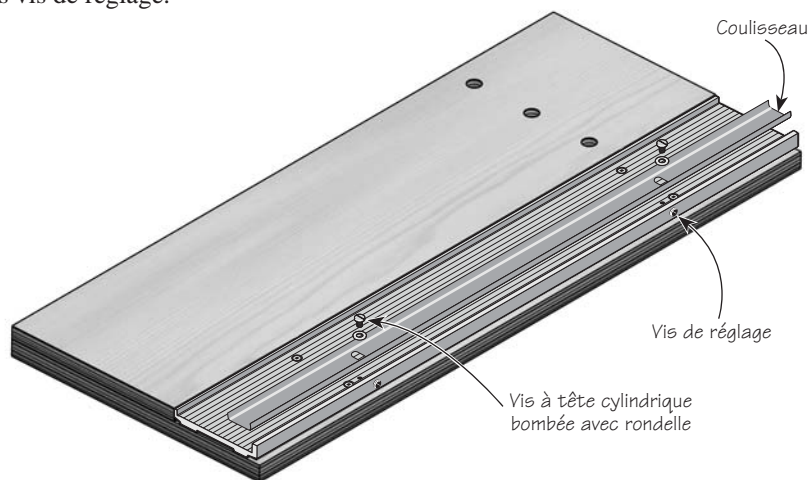
Figure 5 : Mise en place du coulisseau dans la coulisse
